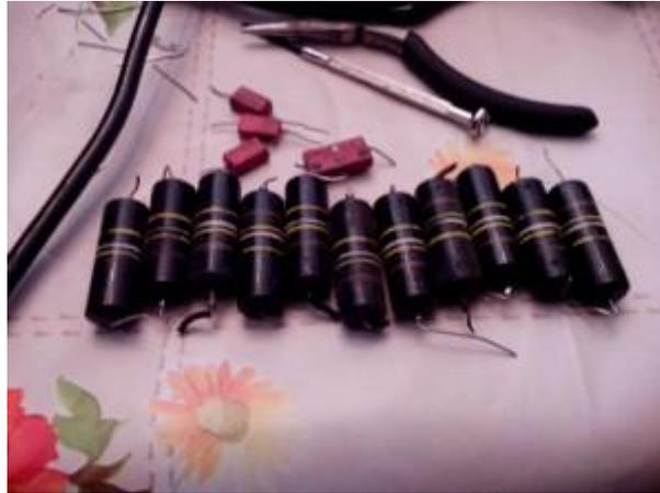
Terminato il recapping, sono passato alla lubrificazione delle parti meccaniche e alla pulizia dei contatti striscianti, potenziometri e commutatori. Operazione che ora era necessaria e propedeutica al passo successivo. Il 75A-4 ha una bella meccanica, diverse pulegge e perni che vanno oliati leggermente. Tutte le parti elettriche mobili vanno pulite con spray specifico e movimentate per bene.
